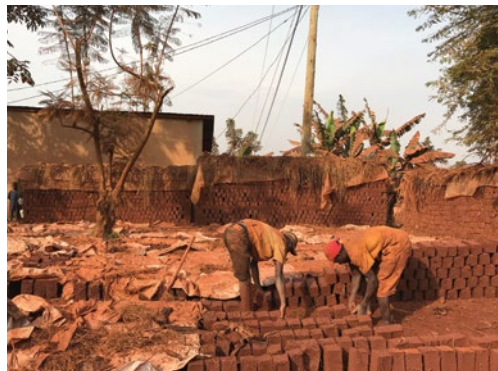
Figura 15. Alex e Juliards colocando os tijolos para secagem. Fonte: Acervo pessoal
